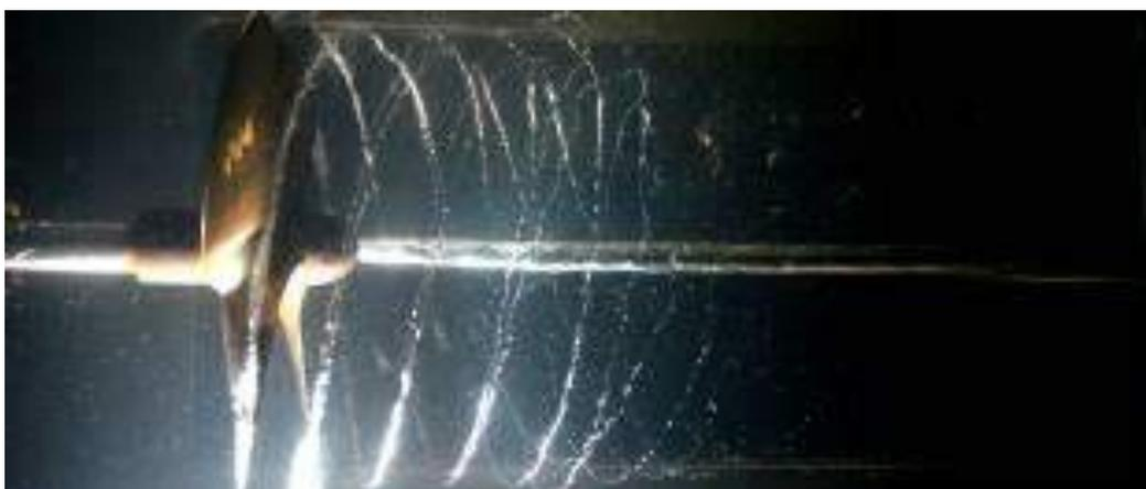
Figura. 8: Cavitação ocorrendo em hélice sub aquática.
